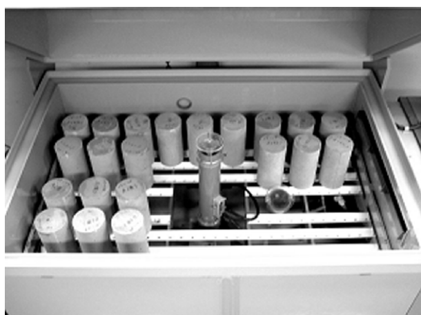
図2 供試体の設置状況
