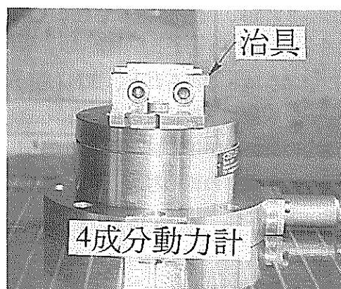
図5 4成分動力計及び治具
