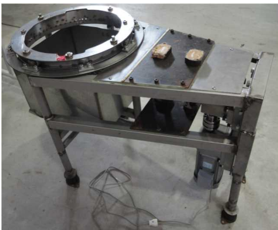
衝動型の搾汁装置(改良後)
