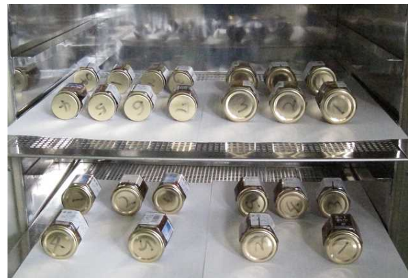
真空引きによる漏れ試験
