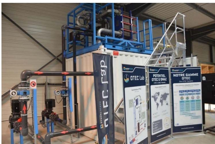
図 1-17 Bardot OTEC 実験装置 [Bardot Ocean 2019]
