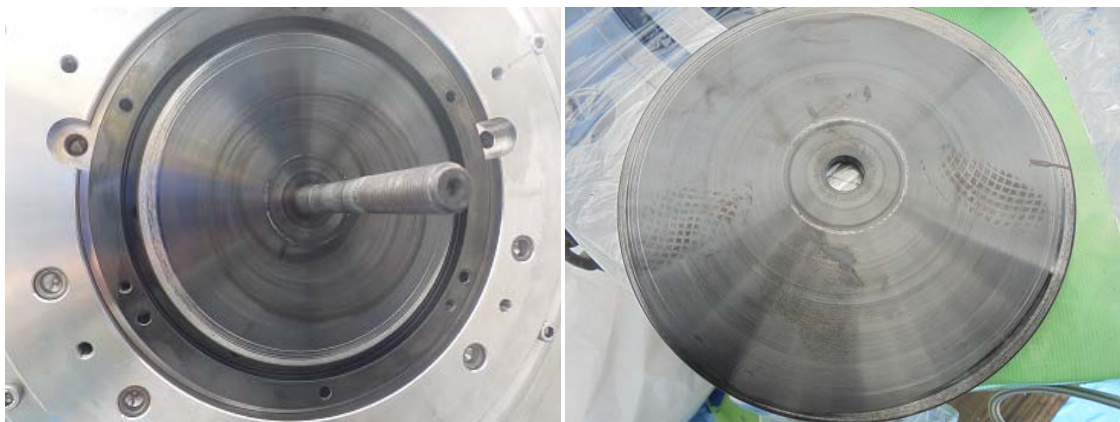
図 2-27 スラストカラー(ブレード側)左:DSS 前、右:DSS 後 擦痕の伸展なし
