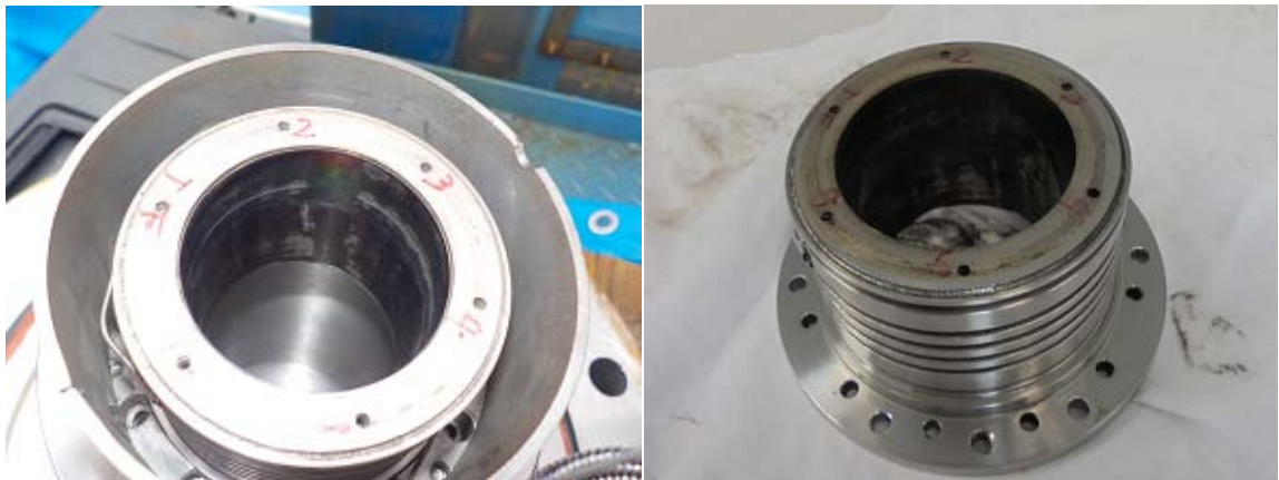
図 2-30 ラジアル軸受(後側)左:DSS 前、右:DSS 後 擦痕の程度はほぼ変わらない ※ラジアル軸受は、平成 28 年 3 月の点検後に新品に交換している
