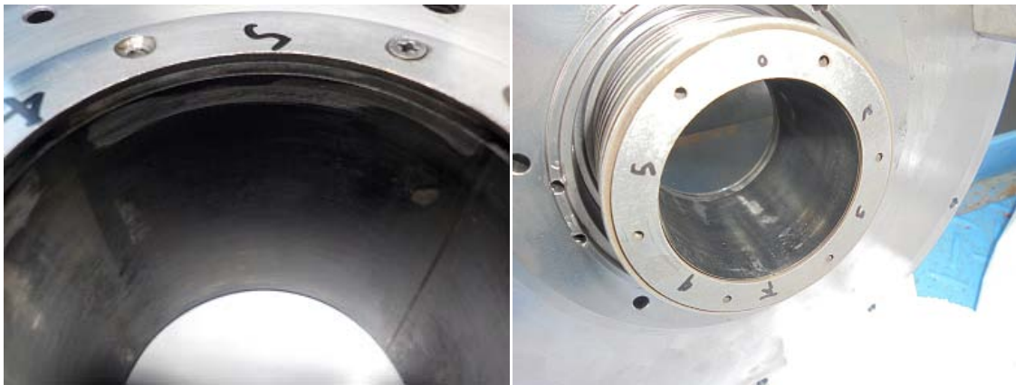
図 2-29 ラジアル軸受(前部)左:DSS 前、右:DSS 後 擦痕の程度は DSS 後の方が若干激しい ※ラジアル軸受は、平成 28 年 3 月の点検後に新品に交換している
