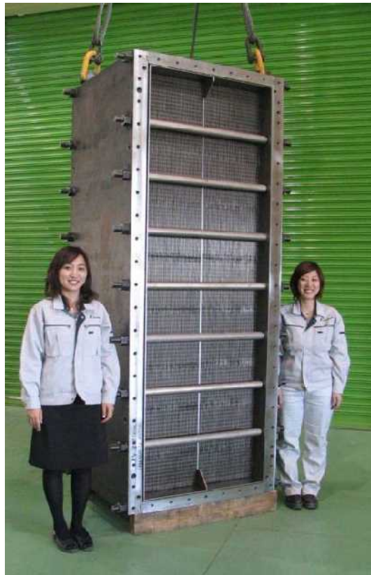
図 3-4 海洋温度差発電プラントに用いられるプレート式熱交換器
