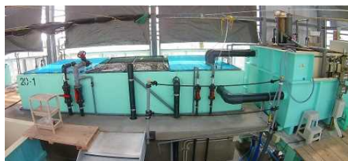
写真1 陸上養殖実用化規模の20kL実験水槽
