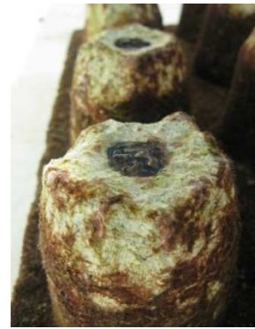
写真6 試験終了時のC型基盤（端部）
