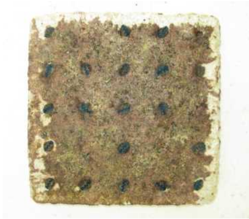
写真3 試験終了時のP型基盤（上面）
