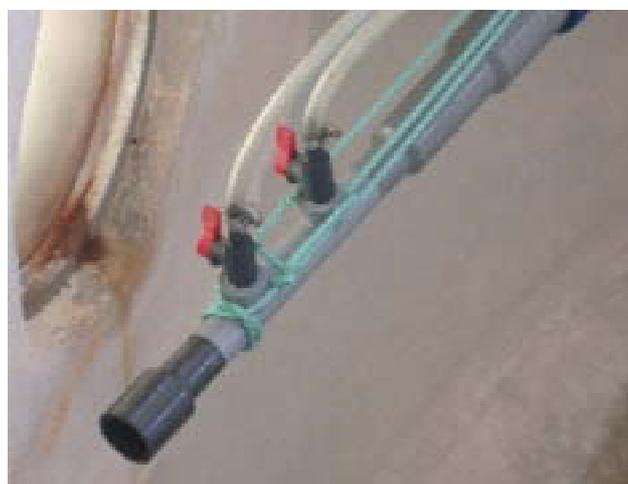
図1 注水口に取り付けたエジェクター
