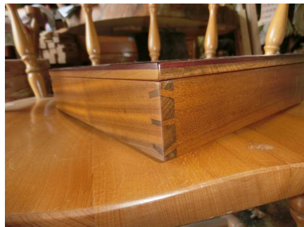
一度組むと分解できない捻り組み継ぎ
