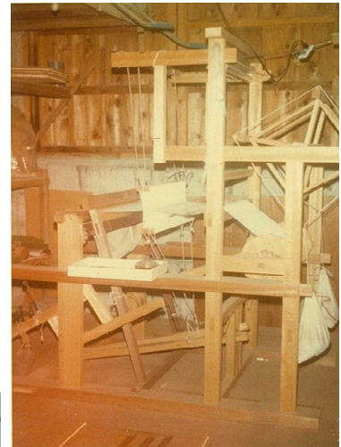
島産材で製作した八重山ミンサー織りの機織り機
