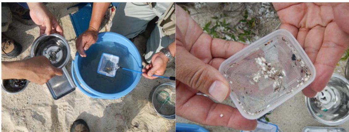
図 3.10-9 浮上したプラスチック等の回収
