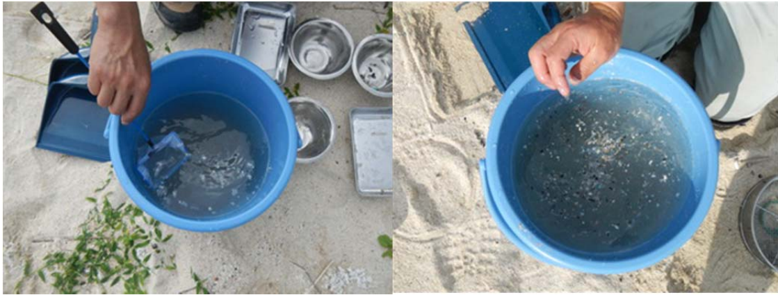
図 3.10-8 攪拌作業（左側）静置後浮上したプラスチック等（右側）
