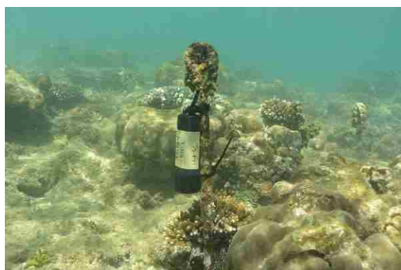
図 2.3-1 水温ロガー設置状況
