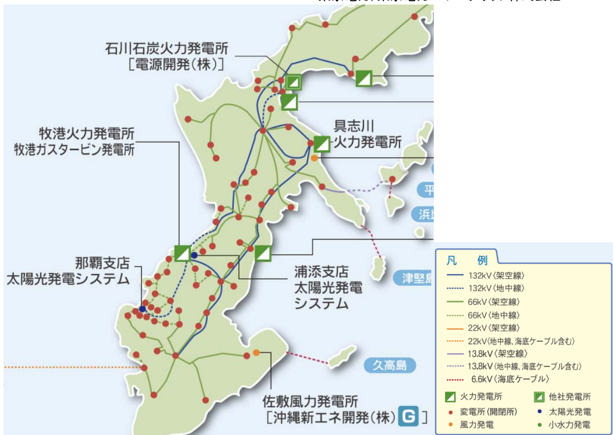
図 I-36 沖縄電力の送電線の状況(H24.3.31 時点)
