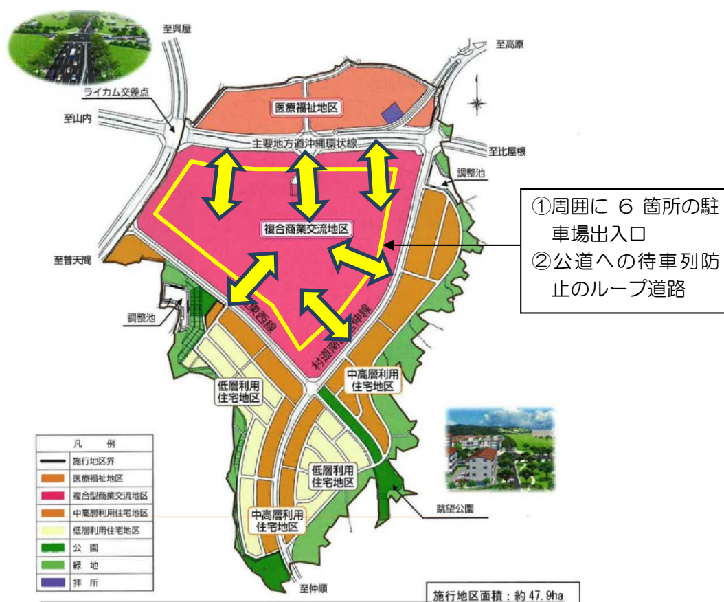
図 2-58 交通負荷増大への対応（駐車場出入口の分散・公道への待ち車列防止）
