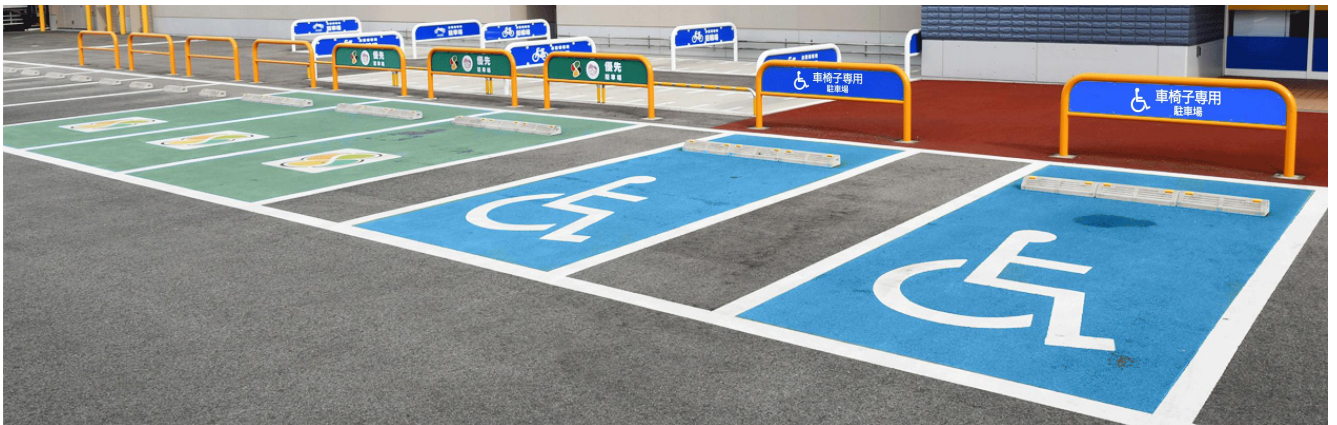
3.5m 以上と 3.5m 未満の駐車区画で利用対象者を分け、床面に表示を行っている事例
