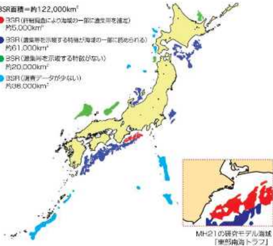
BSR (Bottom Simulating Reflector: 海底擬似反射面) 分布図 (2009年) (出典) メタンハイドレート資源開発研究コンソーシアム
