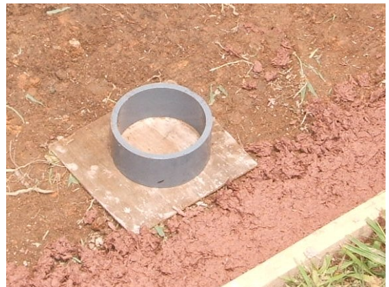
写真-1 供試体採取装置
