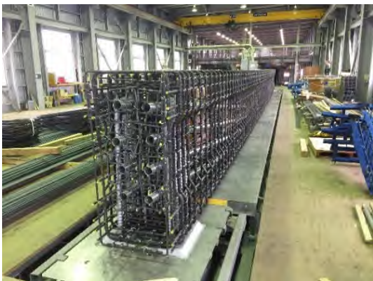
写真 8.33 鉄筋組立状況
