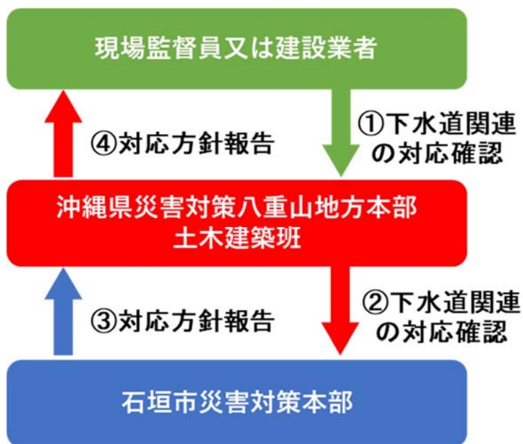
図 3-17 下水道発見の際の対応フロー
