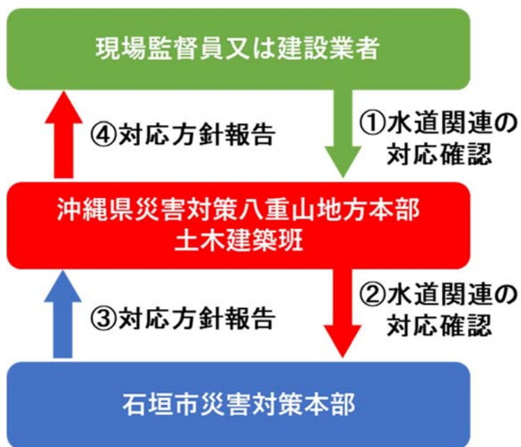
図 3-16 水道管発見の際の対応フロー
