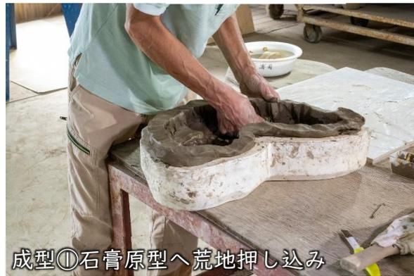
成型①石膏原型へ荒地押し込み
