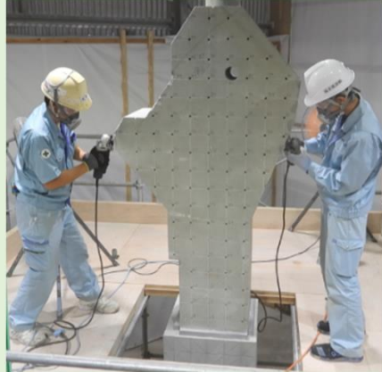
■鬼瓦の石膏原型での造形検討
