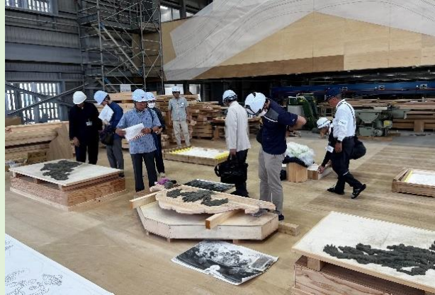
■鬼瓦の石膏原型での造形検討
