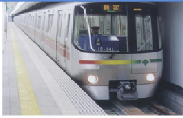
低床化 (小型車輪＋ リニアモーター)
