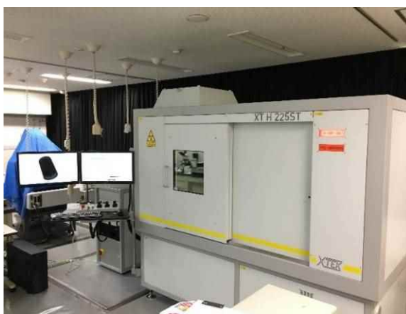
図6.2 地域未来オープンイノベーション・プラットフォーム構築事業により導入した機器 (X線CT検査装置)
