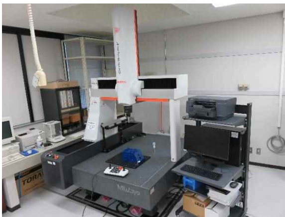
図6.1 公益財団法人JKAの補助事業により導入した機器（三次元測定機）
