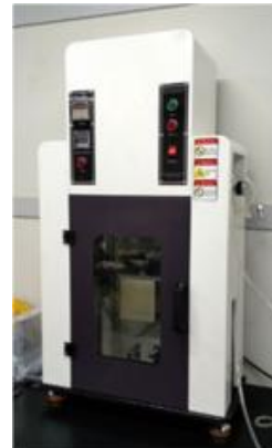
図6.4 卓上縦型射出成形機
