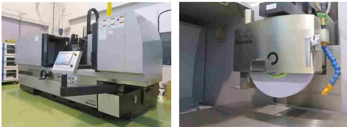
図6.1 公益財団法人JK Aの補助事業により導入した機器（精密平面研削盤）
