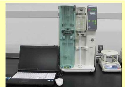
**K-8 水蒸気蒸留装置（アルコール用） 使用料： 140円**
