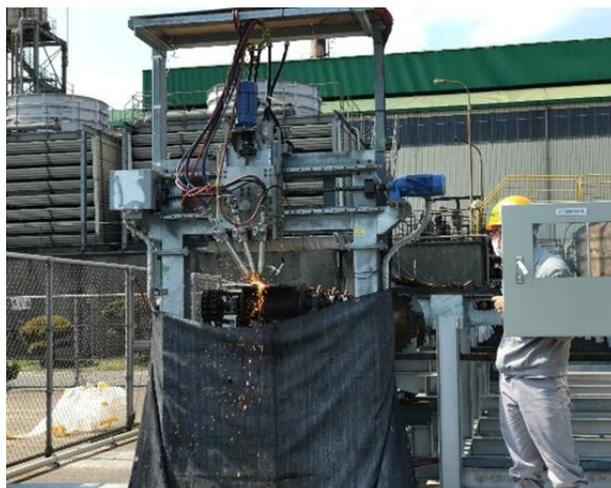
図13 完成した自動切断装置
