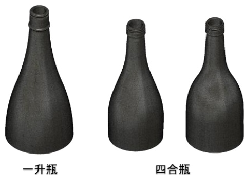
図1 X線CTスキャナにより取得した瓶の3Dデータ
