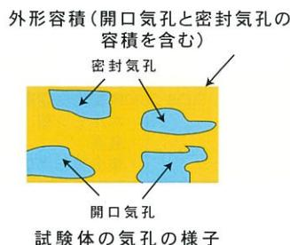
以上の3つの重量（W1、W2、W3）を測定することにより、次式を用いて吸水率、みかけ気孔率、かさ比重、みかけ比重を求めることができます。
