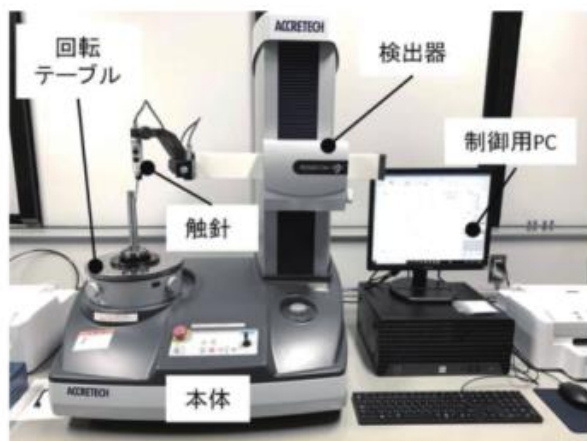
図 2 真円度・円筒形状測定機外観
