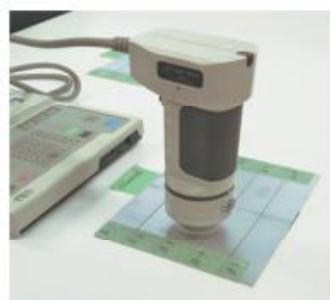
図1 色彩色差計による測定
