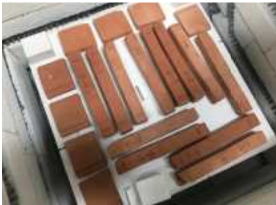
物性測定用テストピース(ガラスを配合した赤瓦素地)
