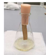
▲グアヤク試験紙法 試験紙が青変で陽性
