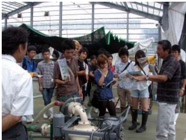
全長25mm程度の種苗を移送するフィッシュポンプ。
