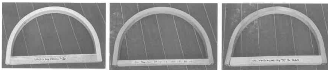
図-2 25mm厚材の曲げ加工 右からリュウキュウマツ、イジュ、イタジイ
