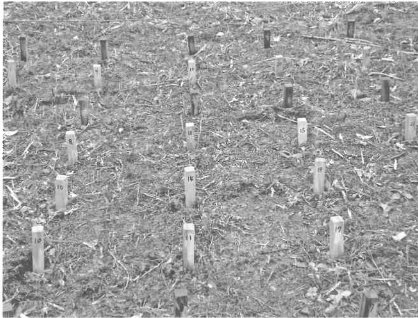
写真-1 野外試験くい打ち試験（嵐山）
