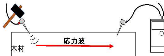
図 2 応力波伝播法の試験原理
