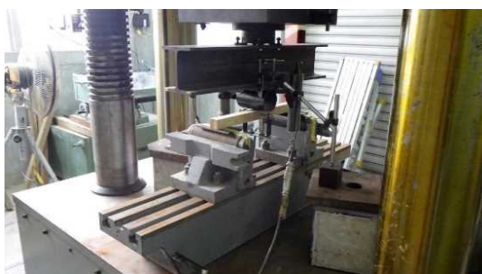
図 5 曲げ破壊試験の様子
