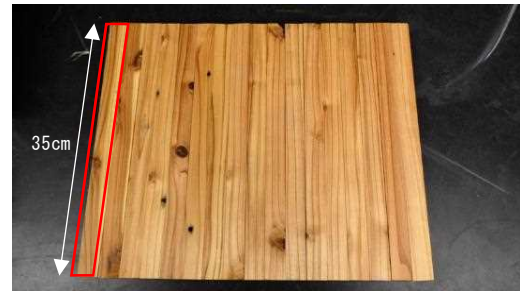
図 8 古材小試験体
