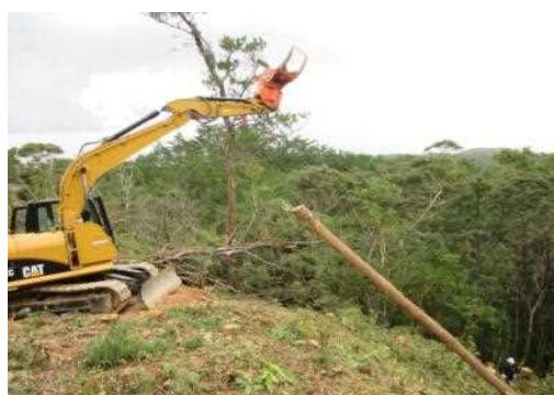
高性能林業機械(スイングヤーダ) を使用した択伐実証試験(国頭村)
