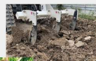
排土型心土破碎機 例：プラソイラ
