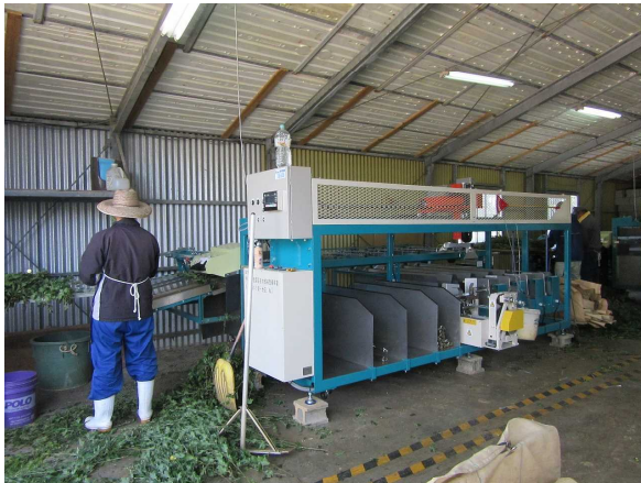
自動結束ロボット付き選花機の導入 (園芸産地機械整備事業)
