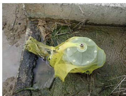
図6 取水口の侵入防止網
