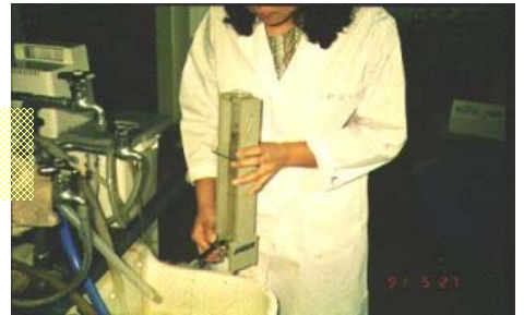
写真1-12 濁りの度合いを測る
