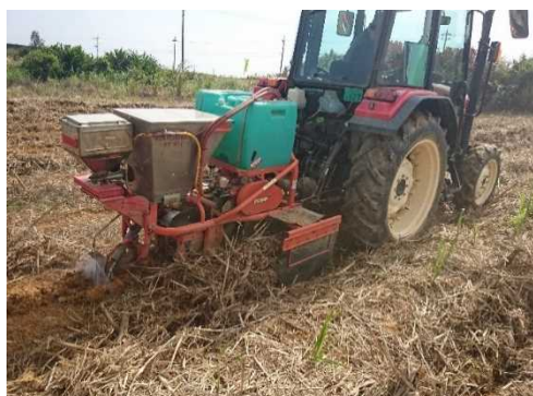
写真1. さとうきび複合型株出し管理機
