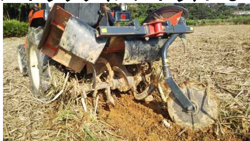
写真3. ブルトラによる葉ガラ除去作業
