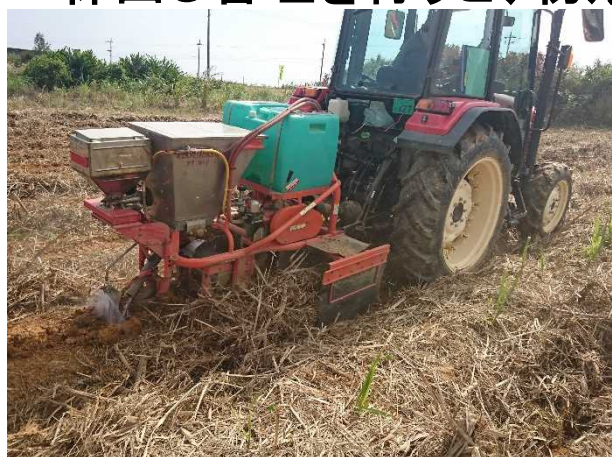
写真1. さとうきび複合型株出し管理機
