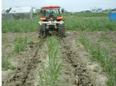
サブソイラによる株出心土破碎作業(左)とサブソイラ施工後ほ場表面(右) 切れ目が入っているだけに見えるが、土中50cm下で、弾丸暗渠を形成している
