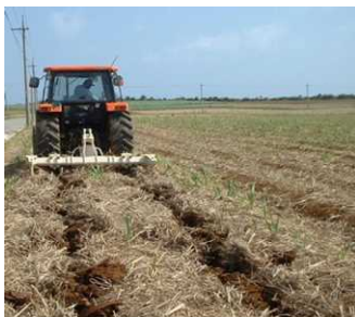
ブラソイラによる株出心土破碎作業(左)とブラソイラ施工後のほ場表面(右) 畦間全体が、地下50cmまで破碎されている
