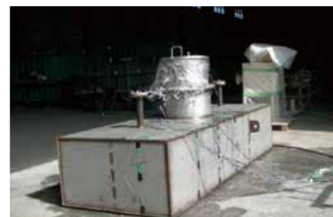
コンボルト型ステンレスタンク。放爆マンホールが作動して圧力を放出した瞬間
