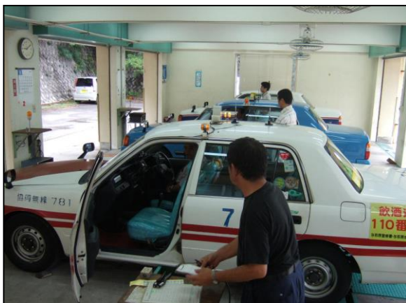
タクシメーター装置検査の様子
