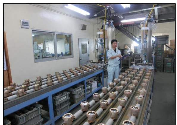
水道メーター検定の様子
