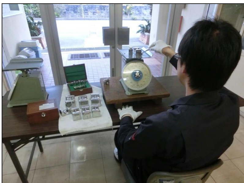
はかり定期検査の様子
