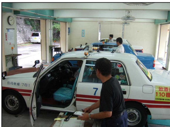
タクシメーター装置検査の様子
