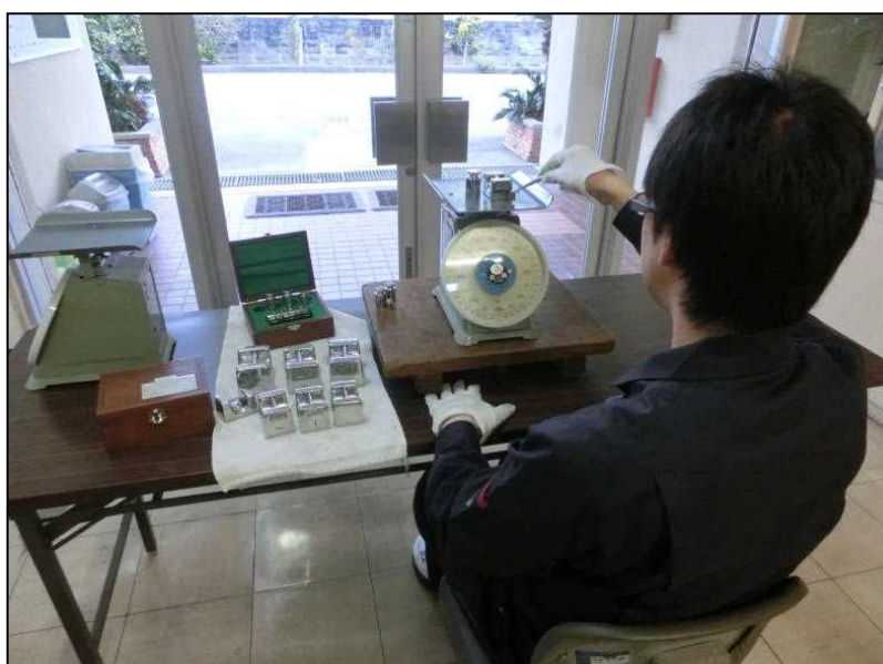
はかり定期検査の様子
