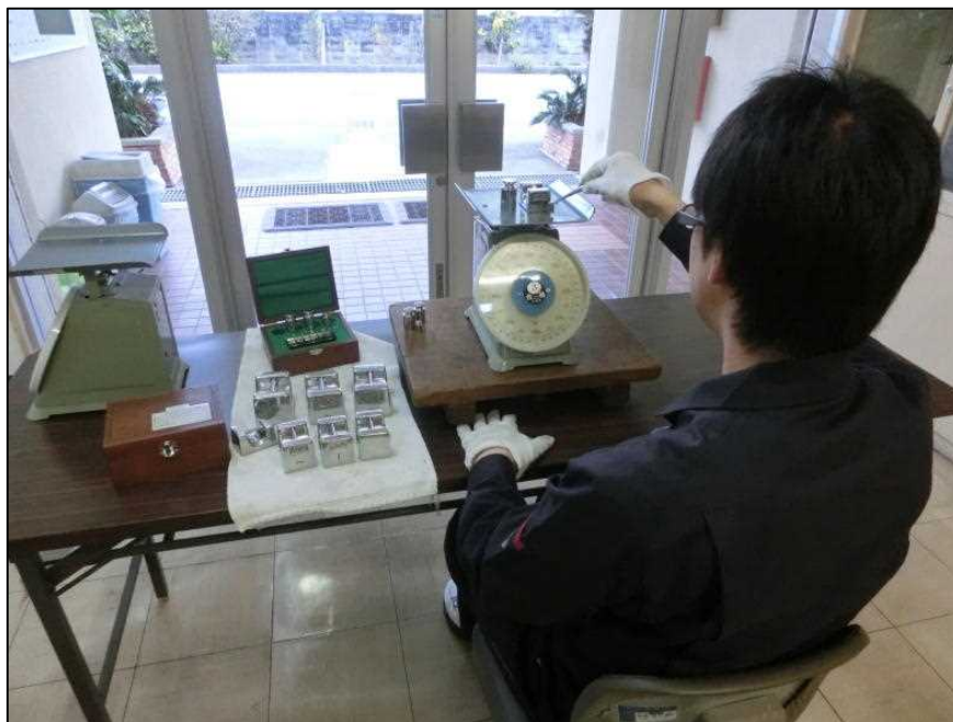
はかり定期検査の様子
